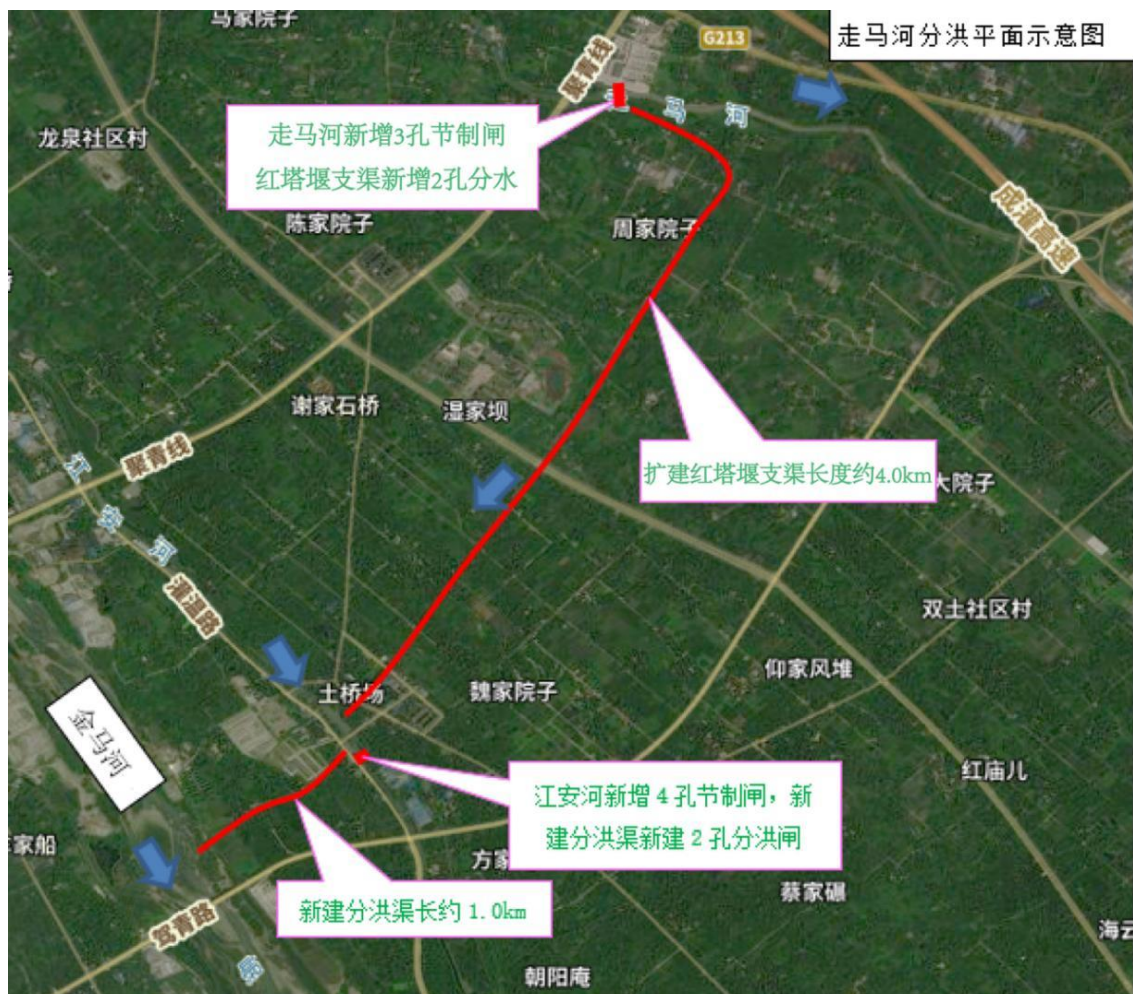
图 6.1-2 走马河分洪工程平面示意图
