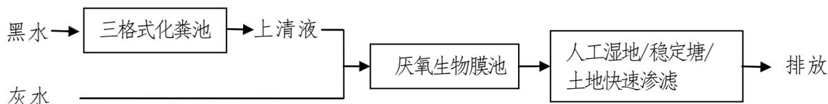
图 6-2 “预处理+厌氧生物处理+生态处理”组合工艺流程图
